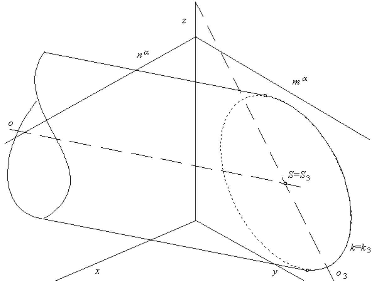
9. Zostrojte priesecníky priamky  $a$  s rotačnou valcovou plochou a rez rovinou  $\alpha \perp \pi$ ,  $a \subset \alpha$ .
